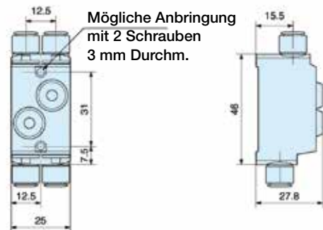
Mögliche Anbringung mit 2 Schrauben 3 mm Durchm.
